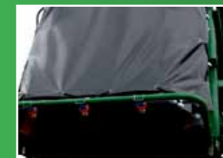
Abdeckplatten und Wasser- sprühsystem zur Staubunter- drückung
