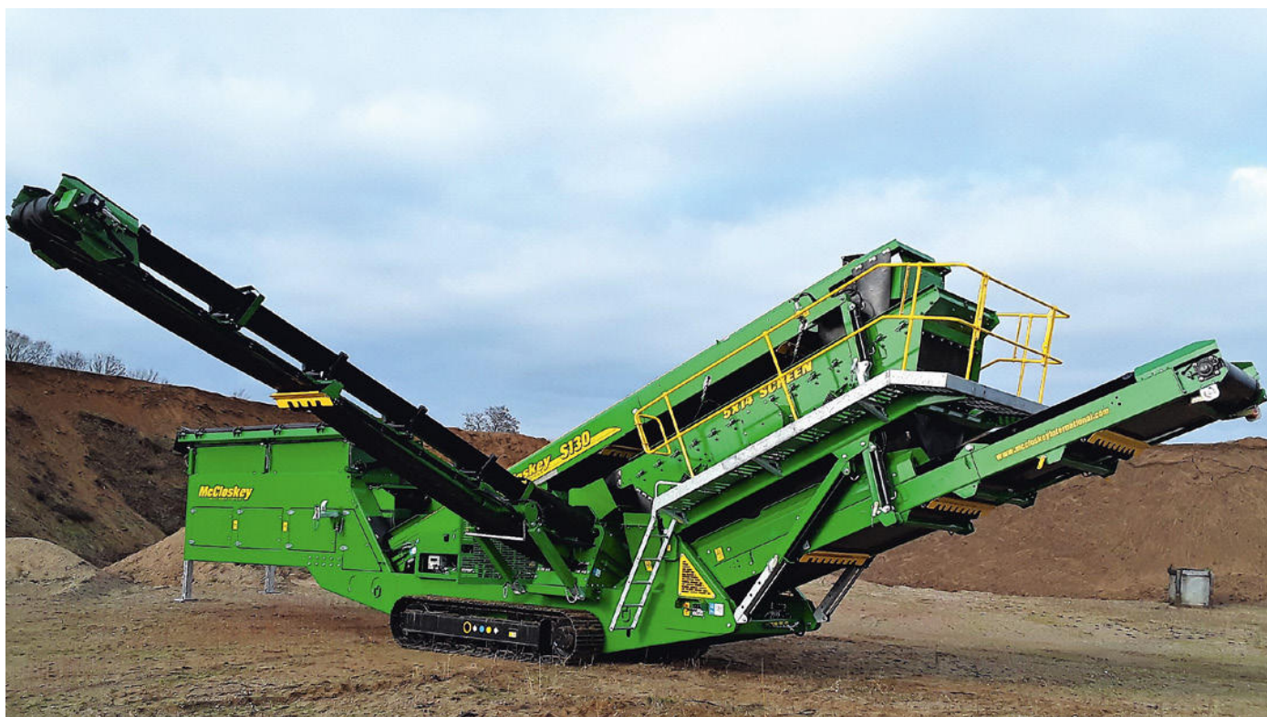
Die Zweideck-Siebzanlage McCloskey S 130 2D ermöglicht durch ihren Hochenergiesiebkasten hohe Siebleistungen in einer kompakten Maschine. | Fotos: Teufelsmoor
