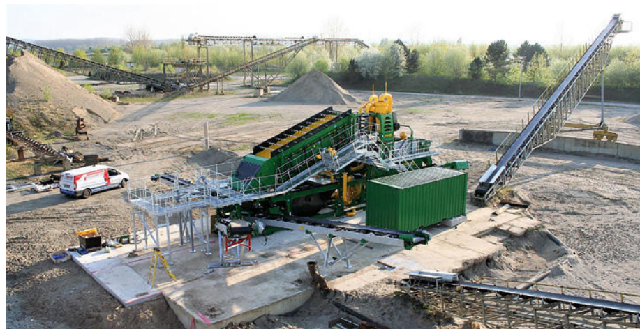
Die McCloskey-Kieswaschanlage Sandstorm 620 3D kann bei einer maximalen Aufgabemenge von 350 t/h bei einer Körnung von 0/5 mm bis zu 200 t/h produzieren.
